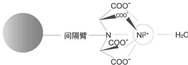
图 1. Ni Smart Beads HF 化学结构示意图
